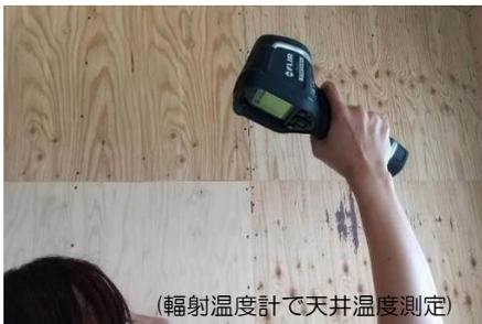
(輻射温度計で天井温度測定)
